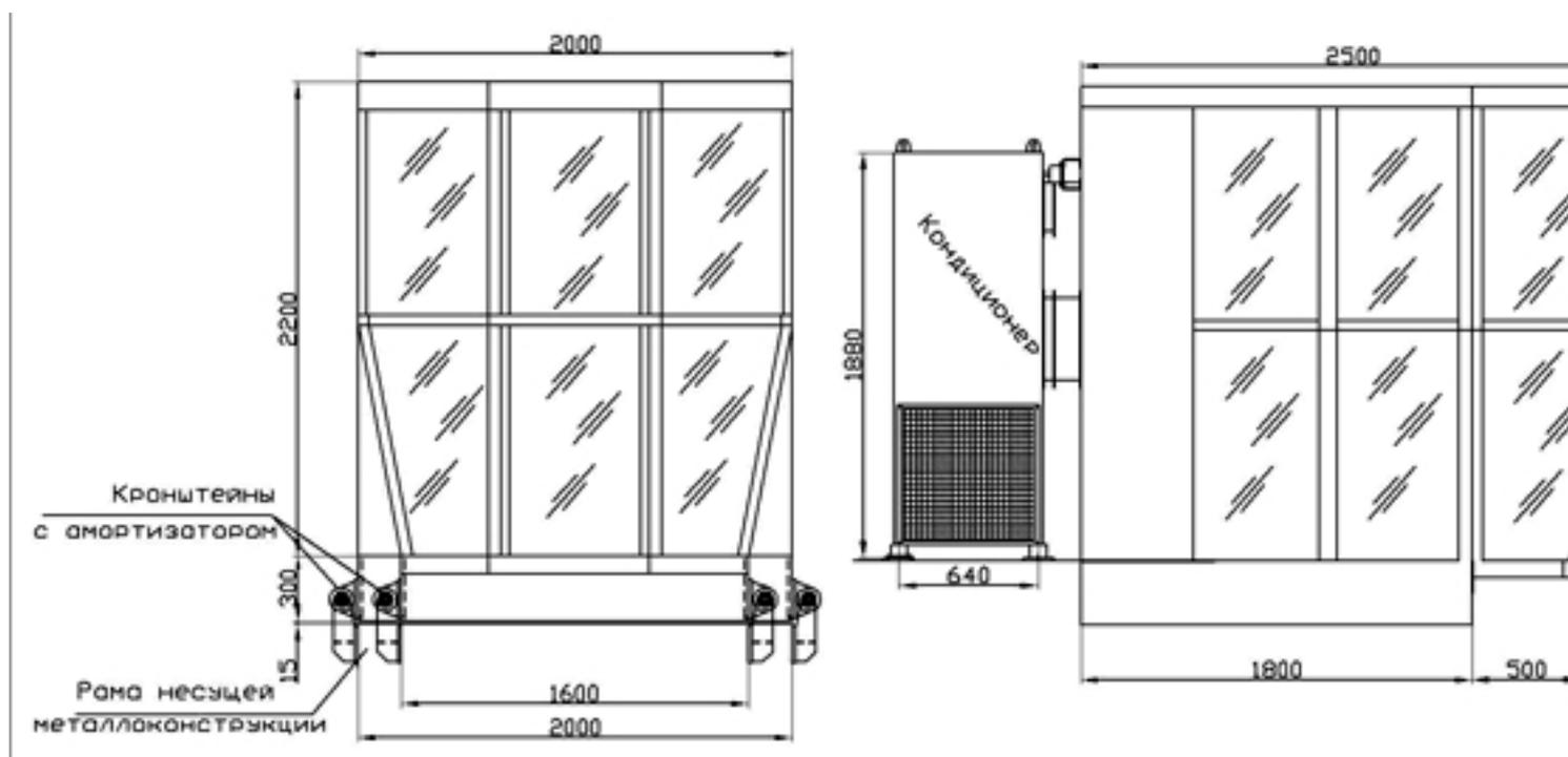
Скраповозавалочные машины оснащены электроприводом и системой управления повышенной надежности, с максимальным резервированием оборудования. Все электрооборудование размещено в кабине управления и двух независимых электропомещениях. Имеется информационная радиосвязь системы управления с АРМ дежурного электрика в электромашинном помещении цеха.
